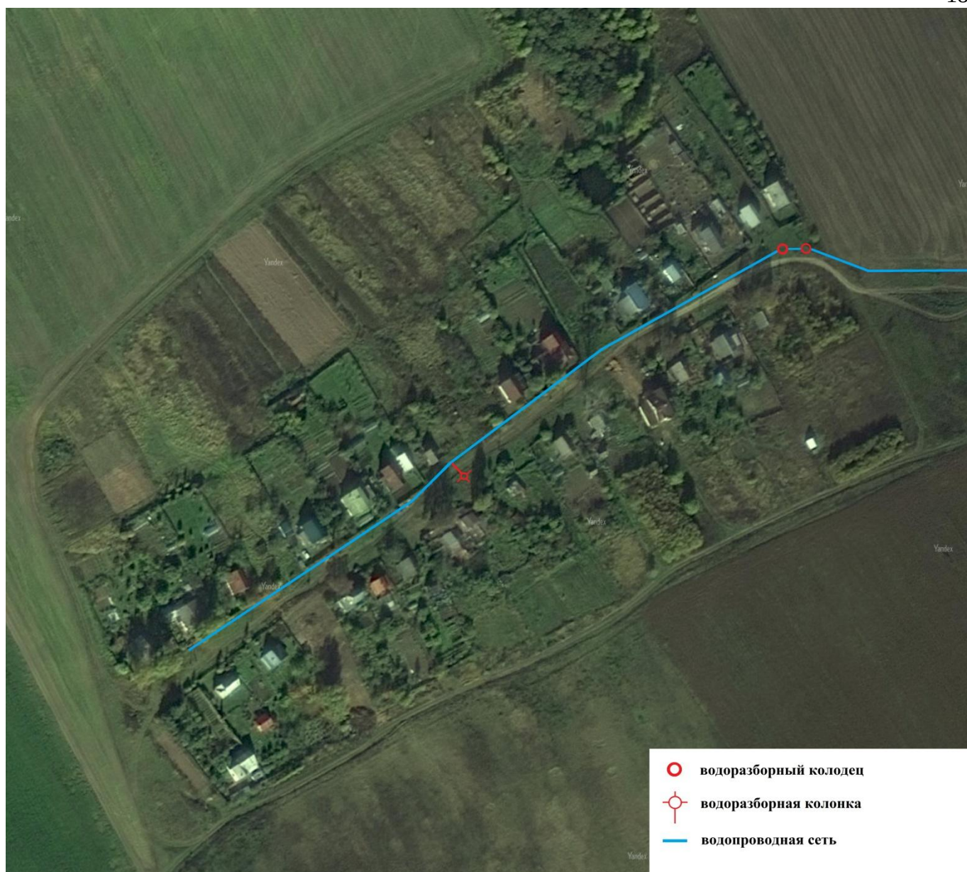
Рис. 2.1.1.3 Схема водопроводной сети д. Лежнево
