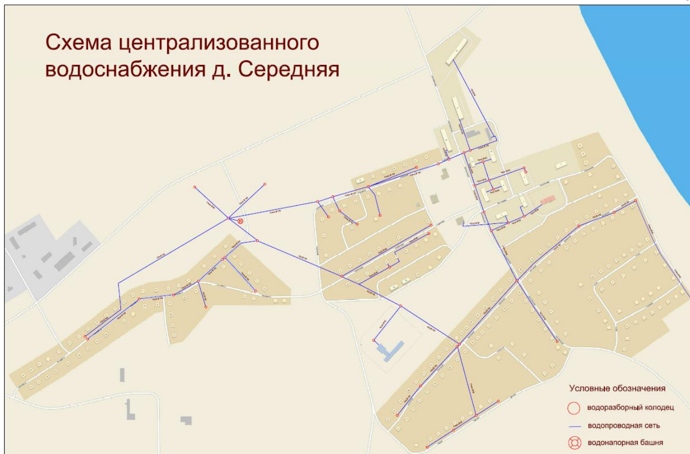
Рис. 2.1.1.5 Схема водопроводной сети д. Середняя и д. Лежнево.
